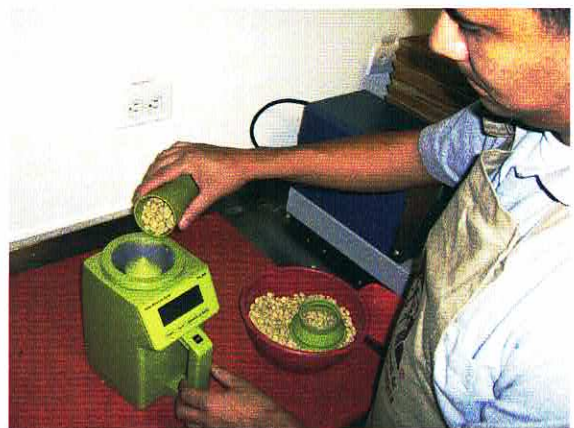
Control de humedad con equipo de medición
