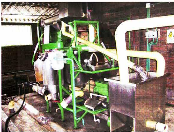
Equipo de despulpado, con clasificadora (zaranda) y desmucilagadora mecánica. Atención a limpieza y mantenimiento.
