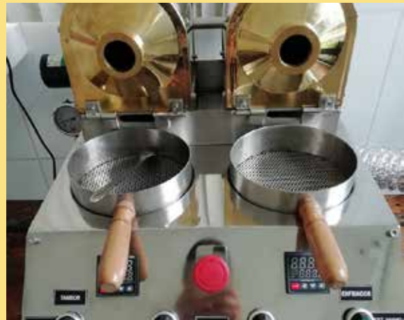
Tostadora para café de 100 gramos con dos bocas.
